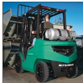
La technologie de moteur sophistiquée de nos chariots frontaux gaz ainsi que la conception innovante de chaque composant et circuit garantissent un haut rendement et de faibles niveaux d'émission. Vous avez le choix entre des capacités de 1,5 à 3,5 tonnes ou de 4 à 5,5 tonnes avec pneumatiques ou entre 2 et 3,3 tonnes et 3,5 à 7 tonnes sur bandage.
