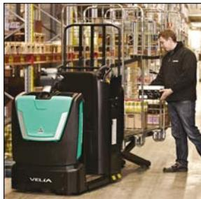
Cette famille inclut des préparateurs de commandes au sol, avec commande au timon ou au volant, ainsi que des préparateurs de commandes grande hauteur, capables de travailler jusqu'à 11,5 mètres de haut.
